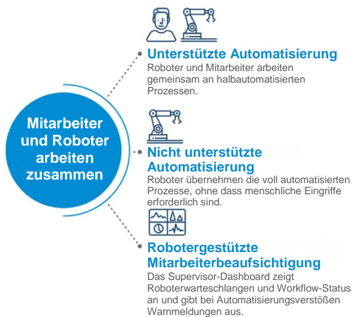
Abbildung 2: Flexibilität bei der Wahl des Automatisierungsniveaus
